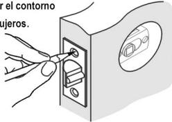
**B.** Hacer un cajeado de 3mm de profundidad para colocar el frente.
