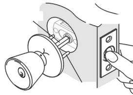
Colocar la parte exterior del pomo asegurándose, que el cuadrillo y los tornillos pasantes atraviesan el picaporte
