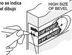
**B.** Marcar el centro del vaciado a 60 ó 70mm.
