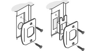
**D.** Colocar el picaporte y ajustar los tirafondos según el dibujo.
