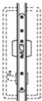
Замок электрически управляется от СКУД. Например замок можно открыть от считывателя с обеих сторон двери.
