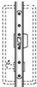
Замок управляется электрически, как с управлением в фиксированное время, так и от СКУД. При управлении по времени, дверь может открыться от импульсов, а при управление доступом дверь можно открыть от считывателя снаружи или от ручки изнутри.
