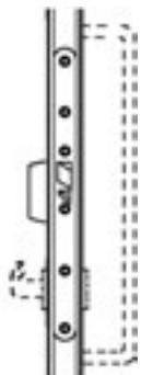
Замок электрически управляется от СКУД. Механическое открывание от внутреннего цилиндра возможно всегда. В случае опасности внутренняя ручка управляется напр. от устройства центральной пожарной сигнализации или от кнопки выхода. В случае обрыва питания механическое открывание от внутренней ручки возможно всегда.
