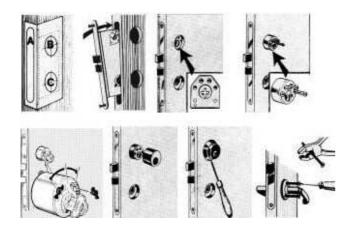
Прежде чем устанавливать замок, убедитесь, что дверь работает корректно. Если хотите установить на дверь уплотнители, то это нужно сделать до установки замка. Последующее уплотнение двери повлечет за собой изменение местоположения ответной планки или переустановки всего замка.
