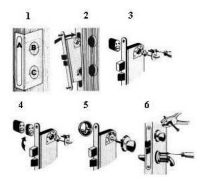
Прежде чем устанавливать замок, убедитесь, что дверь работает корректно. Если хотите установить на дверь уплотнители, то это нужно сделать до установки замка. Последующее уплотнение двери повлечет за собой изменение местоположения ответной планки или переустановки всего замка.
