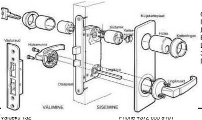
Ответная планка Гильзовые гайки Лицевая планка ВНЕШНИЙ Цилиндр Защитные пробки Подводок ручки
