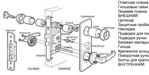
Гильзовые гайки Лицевая планка ВНЕШНИЙ Цилиндр Защитные пробки Накладка Подводок для поворотной ручки Подводок ручки Боковая накладная пластина Гильза Крепежное кольцо на цилиндр Поворотная ручка Болты для крепления ручки ВНУТРЕННИЙ
