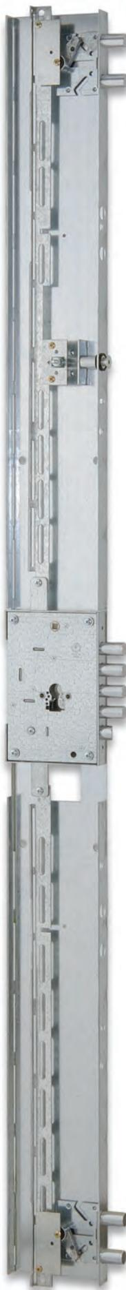
Serratura a fascia rinforzata per porte blindate a cilindro europeo 3 mandate corsa 30 mm. Entrata chiave 63 mm. Completa di 2 deviatori superiori, 2 inferiori e un limitatore di apertura.
