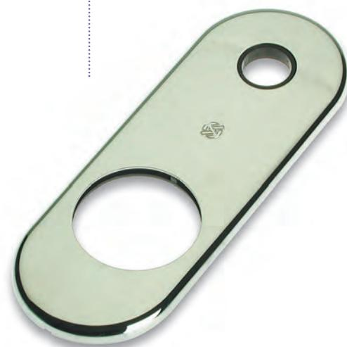
Placca interna/esterna 62x170 mm., foro 46, completa di supporto plastico e adattatori per maniglia Ø 15, 16, 18 e nplex M10. Da abbinare a serrature serie 25 (solo per cuore a doppia mappa) e serie 25M.
