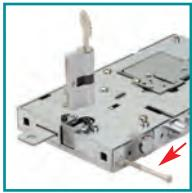
3 catenacci Ø 18 mm. con interasse 37 mm. oppure 4 catenacci Ø 18 mm. con interasse 28 mm. Comando del catenaccio inferiore Ø 18 mm. a cilindro europeo Yale, corsa Ø 20 mm. 2 mandate che aziona sulla prima manda il limitatore di apertura regolabile. Scrocco reversibile Ø 20 mm. azionato da chiavi e quadro maniglia 8 mm. A serratura chiusa la maniglia non sgancia lo scrocco.
