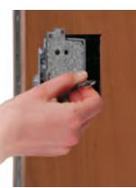
Cuore a doppia mappa universale a 4 mandate, corsa 40 mm, 2 leve indipendenti mano destra o sinistra con 1 chiave da cantiere KA. Il vantaggio di questo cuore è che viene montato in fase di cantiere e permette all'installatore di utilizzare 1 chiave per tutte le porte. A cantiere ultimato viene cambiato il cuore con uno a doppia mappa definitivo 25H o con un cuore a cilindro europeo 25C.
