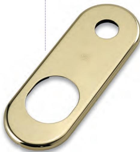
Placca interna/esterna 62x170 mm., asola 42x50, completa di supporto plastico e adattatori per maniglia Ø 15, 16, 18 e niplex M10. Da abbinare a serrature serie 25 universale con cuore a doppia mappa o cilindro.
