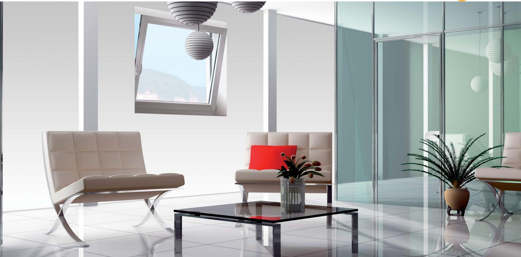
Finestra ad un'anta in PVC con apertura ad anta/ribalta. Vetrocamera 4/12/4.
