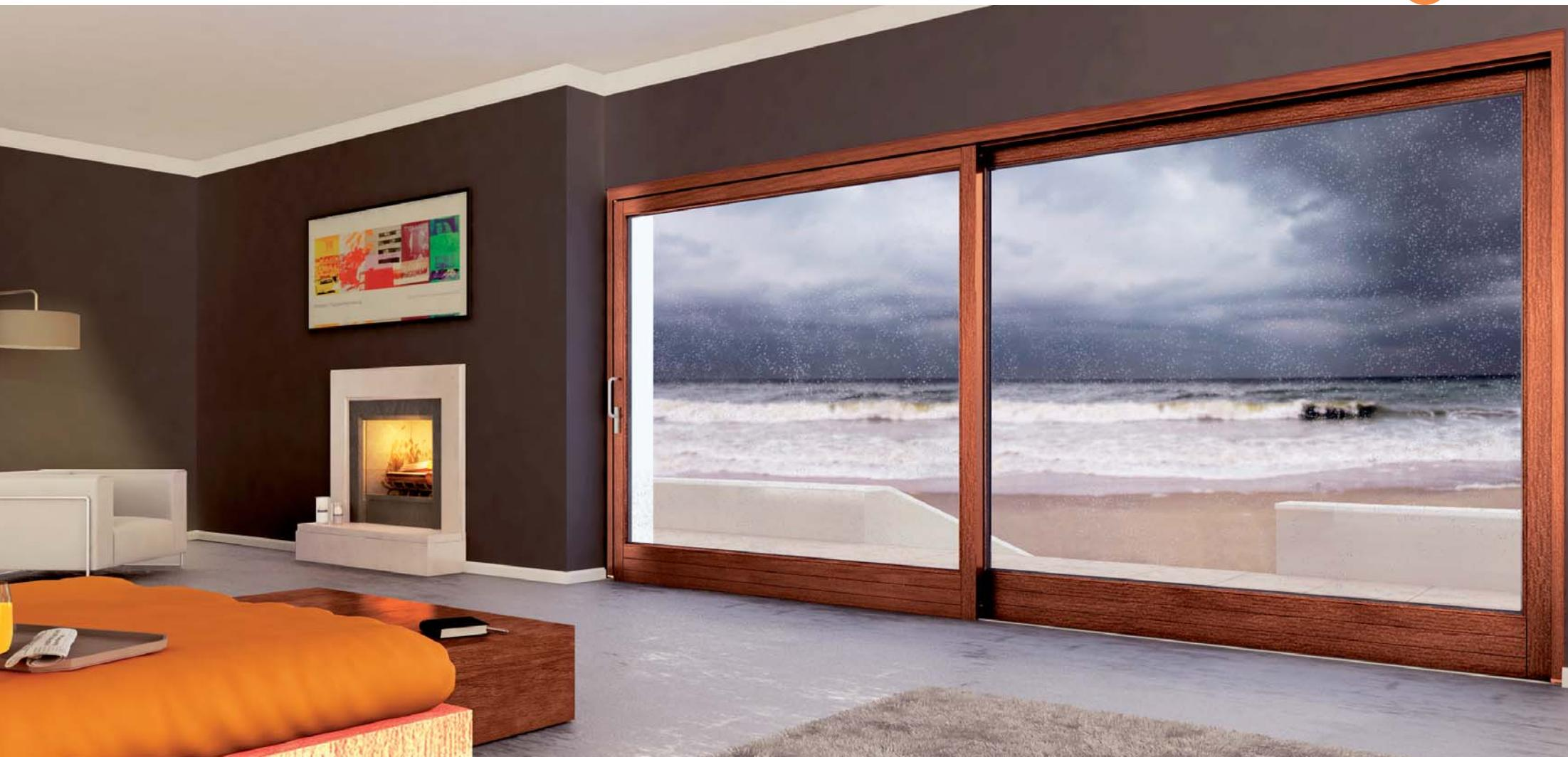
*Serramento in legno di tipo scorrevole, spessore 70 mm, vetrocamera 4/12/4, completo di guarnizione in elaprene, sistema di accessori mod. AGB Alzante Scorrevole con binario basso con soglia in vetroresina Climatech.*
